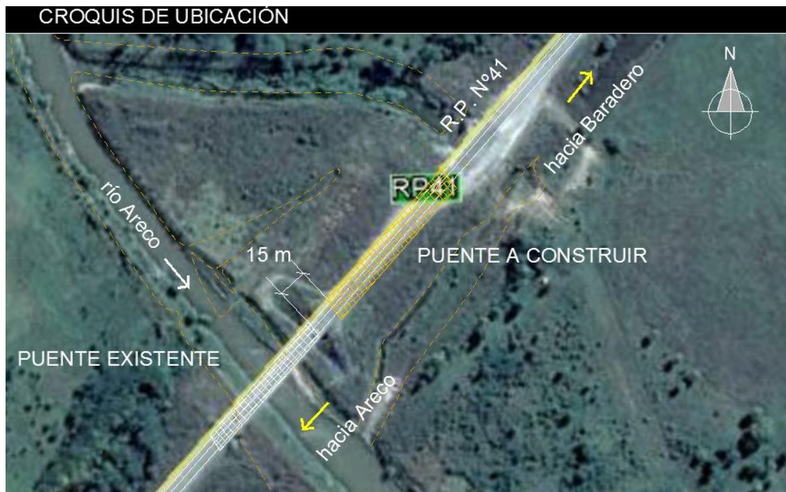
Figura 2-4. Croquis de ubicación del puente sobre el río Areco y RP N°41
