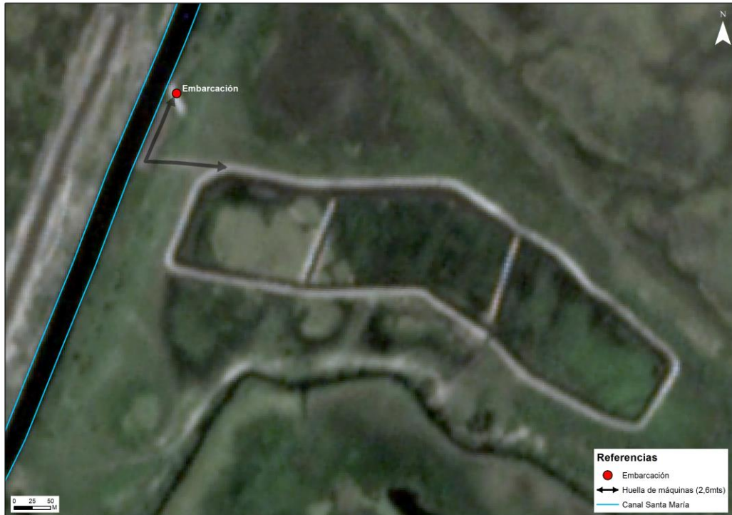
Figura 98: Secuencia constructiva Panel superior 20/11/18 – Panel Medio 04/12/18 – Panel Inferior 22/12/18). Se esquematiza la huella (2.6 mts de ancho) desde y hacia la embarcación de apoyo ubicada sobre margen derecho del CSM.
