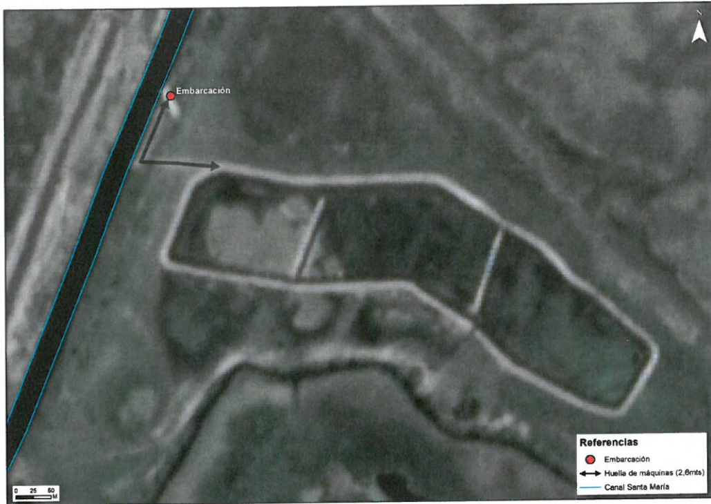
Figura 108: Secuencia constructiva Panel superior 20/11/18 – Panel Medio 04/12/18 – Panel Inferior 22/12/18). Se esquematiza la huella (2.6 mts de ancho) desde y hacia la embarcación de apoyo ubicada sobre margen derecho del CSM.
