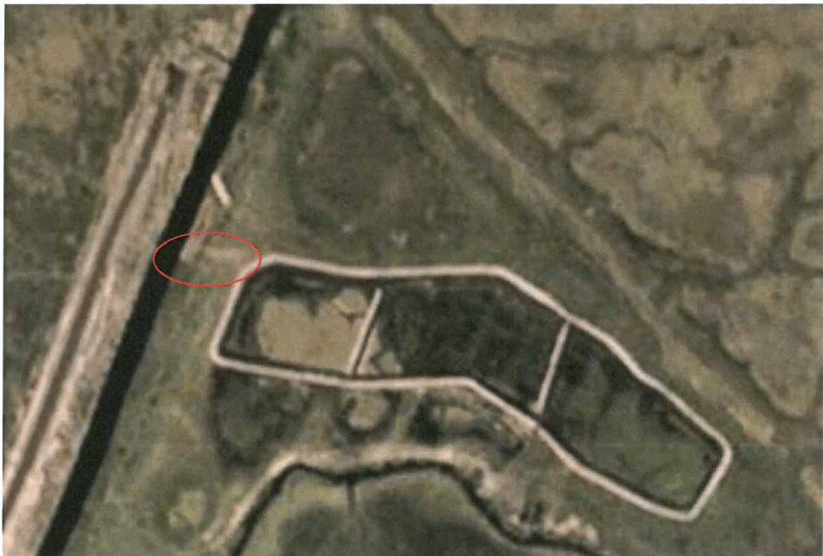
Figura 109: Detalle de la imagen del 24/12/18 con el recinto ya construido. En rojo se indica la huella generada para el acceso de la maquinaria afectada a la obra.
