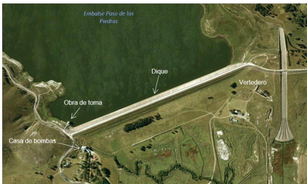
Figura 3: Imagen Satelital – Ubicación Obras Principales
